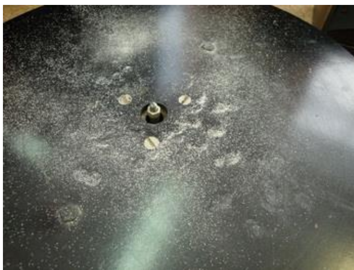
Рис. 6. Распределение крупинок манки на круглой металлической пластине
