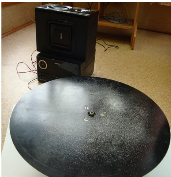
Рис. 6. Распределение крупинок манки на круглой металлической пластине
