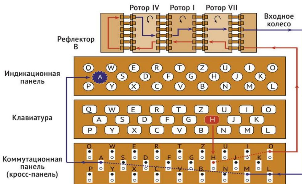
Процесс перекодирования одной буквы в другую обеспечивался определёнными условиями, неизвестными оператору, меняющимися для каждой новой буквы, но поддающимися воспроизведению при аналогичной настройке машины. Таким образом, расшифровать можно было, задав дешифровальной машине тот же режим, что и шифровальной. А поскольку таких режимов было очень большое количество, расшифровать послание, не зная точных настроек, при которых оно было создано, не представлялось возможным.
