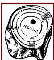
*Ответ. При охлаждении банки давление водяных паров внутри уменьшается по сравнению с атмосферным и банка сплющивается.*
