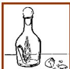
*Ответ. Пламя нагревает воздух в бутылке и часть его выходит наружу. Когда бутылку закрывают яйцом, воздух в ней охлаждается, давление его падает и внешнее атмосферное давление загоняет яйцо в бутылку.*
