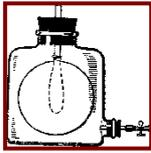
*Ответ. Давление на внутреннюю поверхность резинового шара равняется атмосферному давлению, которое уравнивается давлением воздуха в склянке и давлением упругих сил надутого деформированного шара.*
